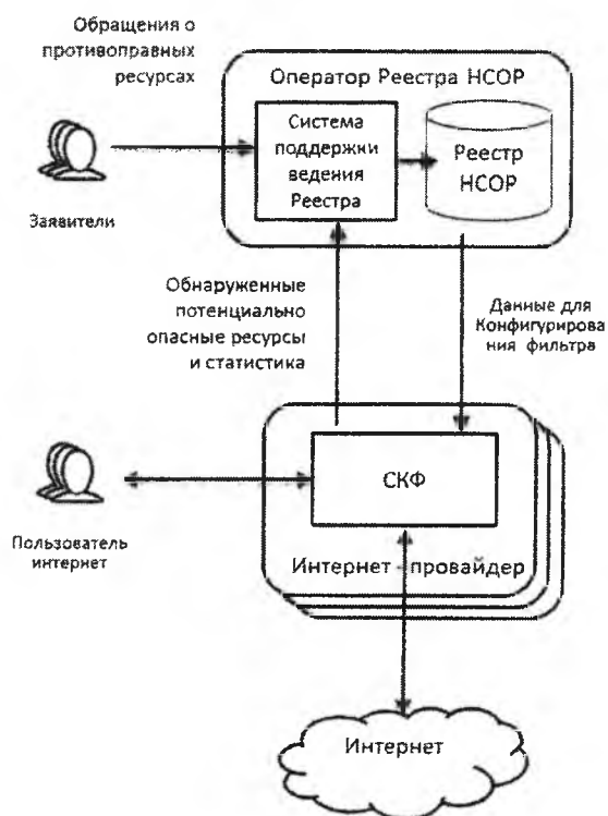
Рисунок 6. Принцип контроля доступа через Реестр НСОР
